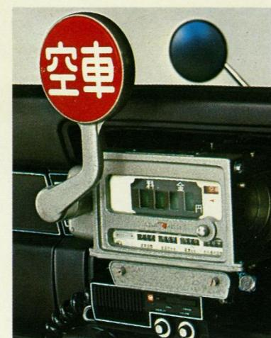
料金メーターもタコグラフも、すっきりと収まるタクシー専用計器盤。厚いパッドに覆われた一体成形の計器盤はタクシー専用の設計です。前席に危険な突起をつくらず、料金メーターやタコグラフが、計器盤の中にきちんと配置できるよう、十分なスペースを計器盤に確保しました。見やすい計器類と操作のラクなスイッチ類が安全運転を生む機能的な計器盤。
